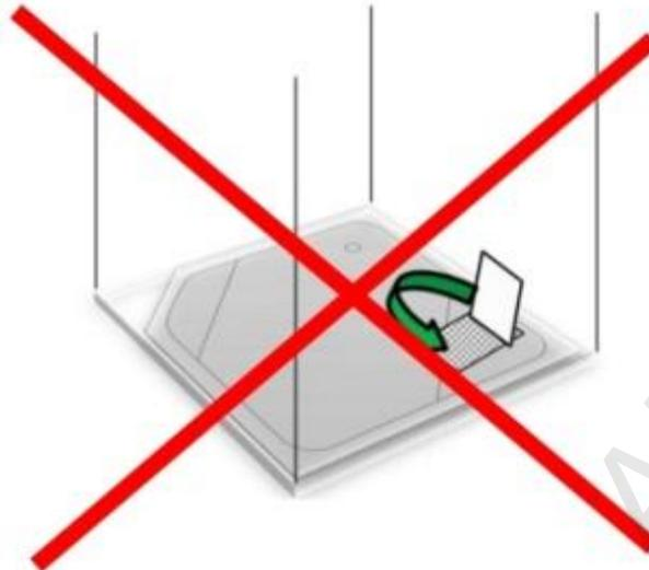
Figure 701F : exemple de trappe en VOLUME 0
