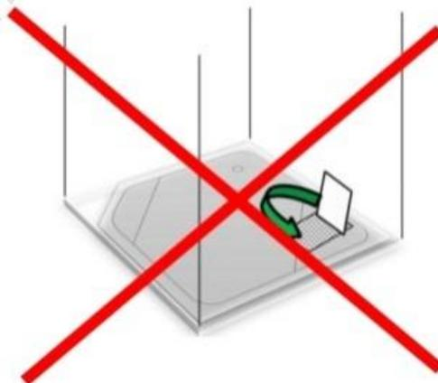
Figure 10-1D : exemple de trappe en VOLUME 0
